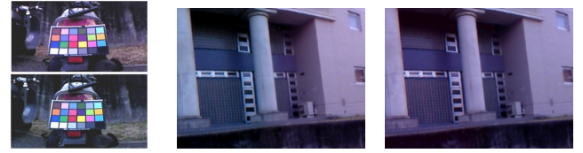
図 8 カメラ間の色補正. 異なるカメラで撮影されたカラーチャート (a) を元に，それらのカメラの映像境界部分 (b) で色補正を行った結果 (c).
