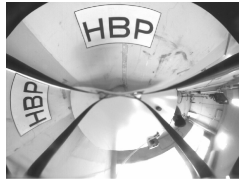
図 3 図 2 で示した試作機による入力画像例．視覚系から同距離に配置した同じ大きさの文字“HBP”が方位によって異なる大きさに射影される．
